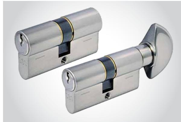
**Cilindar brava** – postavlja se na sobna vrata kada postoji potreba za zaključavanjem ključem sa obe strane vrata. **Sa leptirom** – za potrebu za zaključavanjem vrata ključem samo sa jedne strane.
