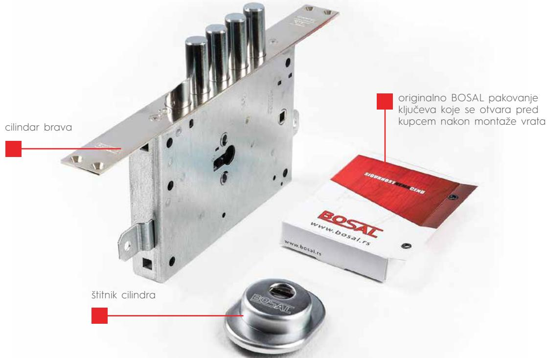
Sigurnosna cilindar brava **Mottura 85.971** je opremljena specijalnim štitnikom sa spoljne strane koji sprečava bušenje i lomljenje cilindra. Osigurava vrata u šest tačaka pružajući maksimalnu sigurnost. Cilindar sa unutrašnje strane može imati leptir koji olakšava zaključavanje i otključavanje vrata. Brava je opremljena kvalitetnim **Mul-T-Lock** Interactive plus ili **Mottura** Champions pro cilindrom.
