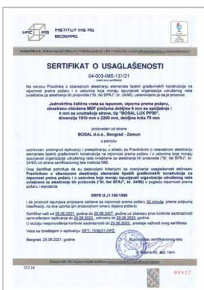
Atest na protipožarnu otpornost PP30 (jednokrilna vrata - LUX model)
